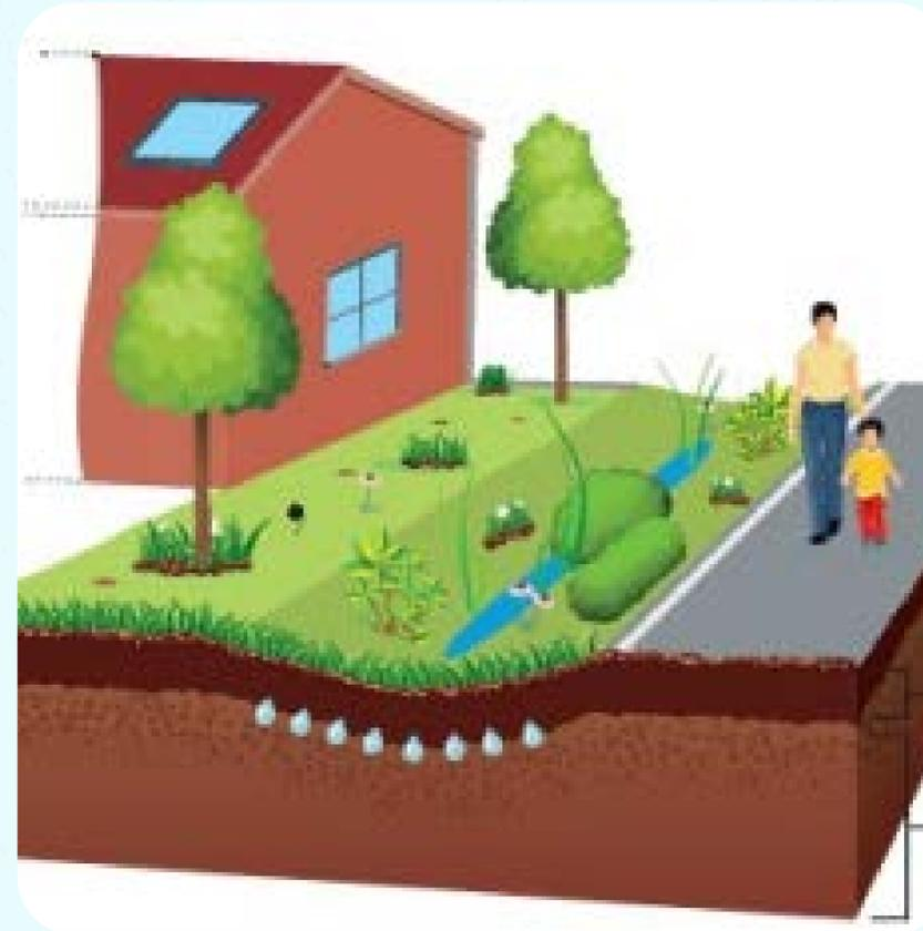
Une noue est un fossé peu profond qui est végétalisé. Elle permet de recueillir l'eau de pluie, pour la laisser s'évaporer ou s'infiltrer dans les nappes d'eau souterraines
